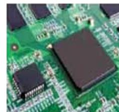
Figura 6. Close-up de uma placa moderna com dispositivos de montagem de superfície, destacando-se o componente maior por ser BGA (Ball-grid Array) onde as soldagens são realizadas por baixo do encapsulamento.
