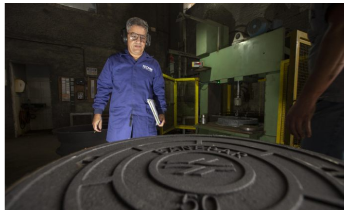
Inspeção em tampas de ferro fundido. Foto: Hedeson Alves/TECPAR
